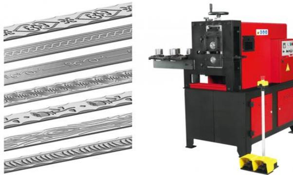
В зависимости от выбранного вальца на станке для художественного проката NOA60 Nargesa можно прокатывать холодным способом различные по дизайну рельефы на металле. Вальцовочный станок дляковки очень популярен в работе с художественной ковкой для нанесения различного дизайна на полосы, прутки поперечного или квадратного сечения, для перильных ограждений, поручней, решеток и так далее, добавляя материальную и художественную ценность изделию.
