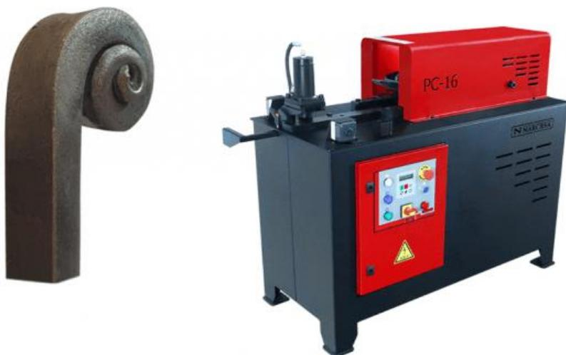
Станок для горячей ковки Nargesa РС16 закручивает конец заготовки, придавая ей желаемую форму. Обычно полученные детали используются для декоративного оформления ворот, окон, ограждений, мебели и так далее
