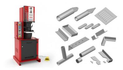
Многофункциональный гидравлический пробивной пресс **MX340G Nargesa** с максимальным усилием более 40 тонн. Наличие горловины, максимальная длина хода гидроцилиндра и широкая рабочая столешница превращают этот станок в универсальный инструмент: он пробивает отверстия, сгибает, режет, выгибает формы и т.д.
